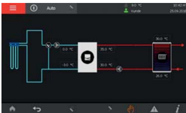
Großformatiges Farb-Touch-Display der Regelung Vitotronic SPS 2.0 mit übersichtlicher Anzeige
